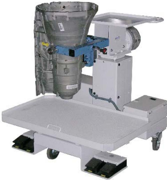
Dieser Universalmontagewagen wurde speziell für einen Automobilbauer entwickelt um bei der Getriebeentwicklung möglichst flexibel und ergonomisch arbeiten zu können.
